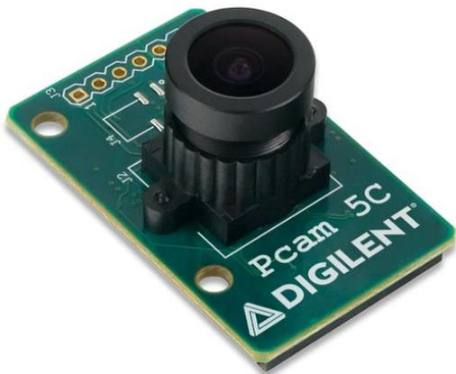
Pcam 5C è dotato di un obiettivo a fuoco fisso installato su un attacco M12 standard che consente l'intercambiabilità degli obiettivi. È applicato su un circuito stampato di piccole dimensioni (4,0 x 2,5 cm), dotato di un connettore diritto 1x7 100-mil per l'accesso ai segnali ausiliari. Tra i formati di uscita figurano RAW10, RGB565, CCIR656, YUV422/420 e YCbCr422.
